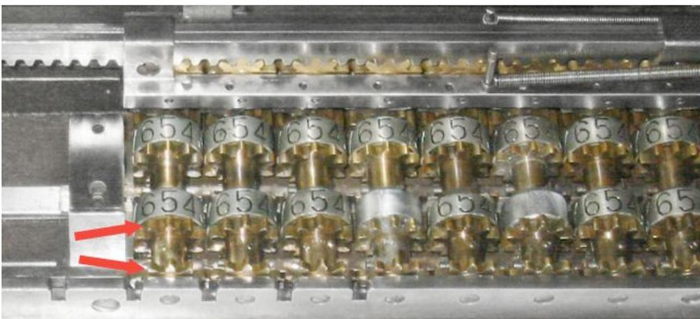
Abb. 18 der Schlittenunterseite: Resultat- (unten) und Umdrehungszählwerksstellen (oben) besitzen jeweils eine gemeinsame Welle. Resultatwerk (Pfeile): Die Zahnäder in Höhe des unteren Pfeils sind an die Einstellwellen des Rechenwerks gekoppelt. An die Zahnradreihe darüber (oberer Pfeil) wird der Zehnerübertrag übergeben (vgl. Abb. 16, oben).
