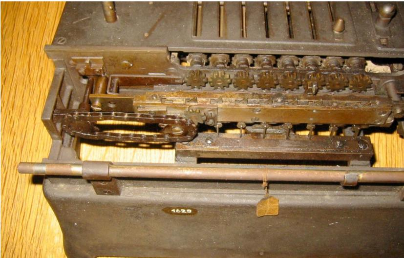
Abb. 10: Wie Abbildung 9, Aufnahme von hinten. Mitte links die völlig verhärtete Kette für das Umdrehungszählwerk.
