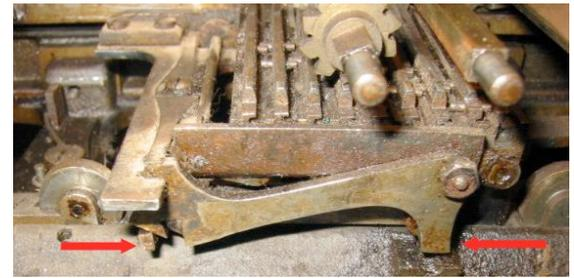
Ein Teil des Hebemechanismus der Staffelplatte - aufgenommen beim Ausbau. Man erkennt die Rollenlagerung der Platte. Durch Anschläge bei den Wendepunkten der Platte - bei den jeweiligen Pfeilen - wird die Platte gehoben bzw. gesenkt.
