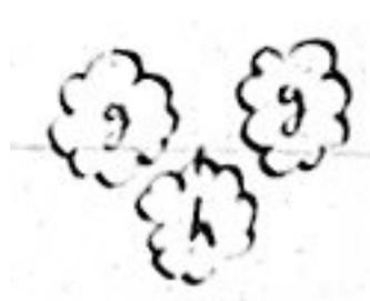
*Beigefügt war neben der obigen, bekannten Zeichnung diese Randskizze. Wir sehen drei Zahnräder, wobei die beiden oberen auf jeweils einer Einstellachse zu denken sind. Das untere ist das Zwischenrad, das die Drehrichtung der oberen Achsen gleichsinnig erhält sowie jenen, über den Zahnkranz hinausragenden, Einzahn trägt, den ich oben bereits erwähnte und der das entscheidende Konstruktionsmerkmal darstellt.*
