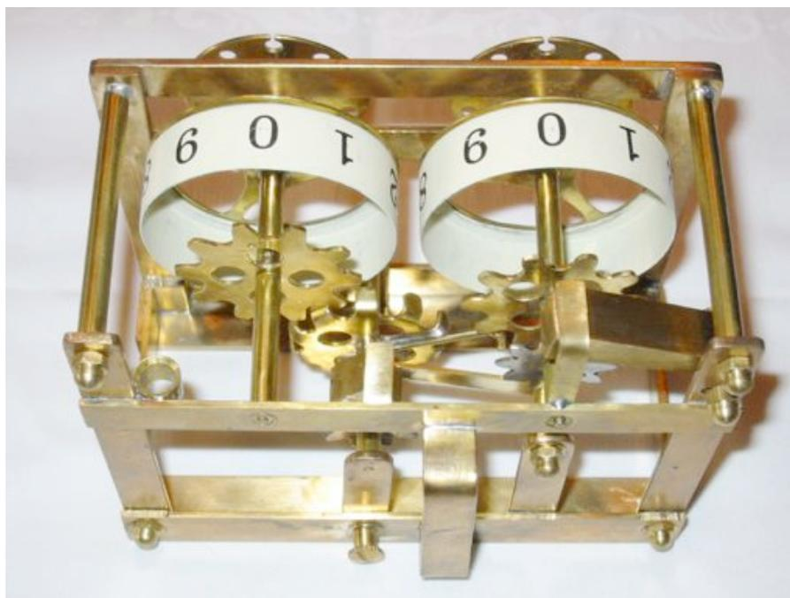
*Der Blick von oben zeigt die gegeneinander versetzten Ebenen der Zahnräder. Eine Fortsetzung der Achsenreihe nach links (auf dem Foto nach unten) ergäbe als nächstes eine Zwischenachse mit Zwischenrad, dessen Zähne in die entgegengesetzte Richtung (auf dem Foto nach unten) zeigen, der Einzahn wäre entsprechend oben montiert. Auf diese Weise würde man alternierend fortfahren.*
