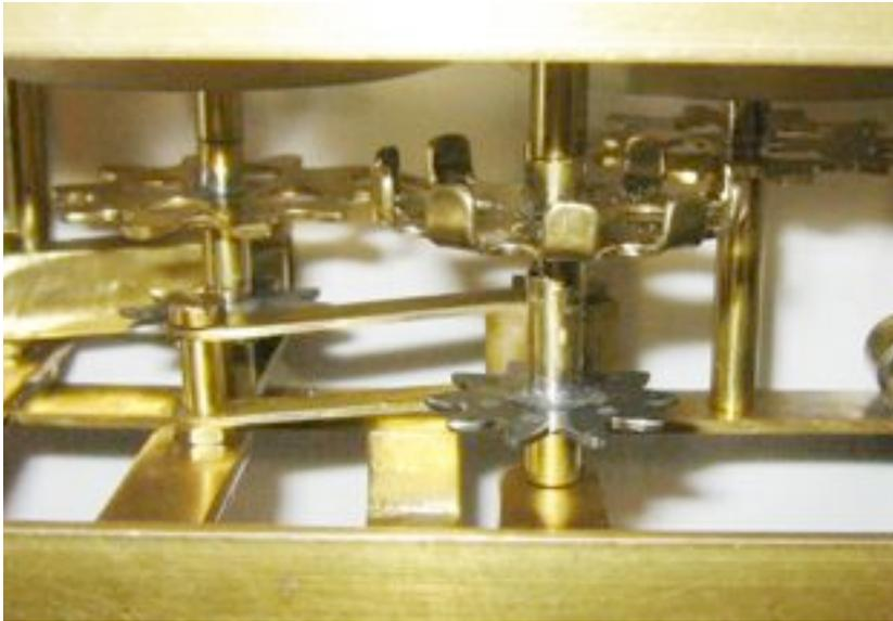
*Von unten gesehen. Man erkennt hier, dass auf der Zwischenradachse die Zähne beider Zahnräder um 18° versetzt sind.*
