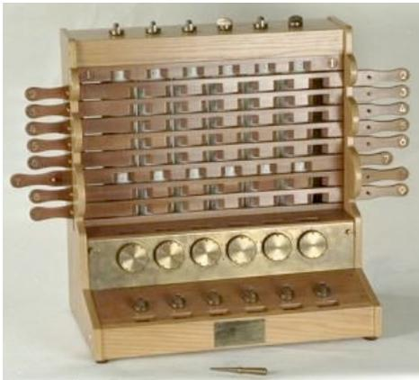
*Die Tübinger Rekonstruktion in der Gesamtsicht. Der zentrale Bestandteil und die eigentliche Rechenmaschine ist das Addierwerk, der Rest sind ergonomisch-praktische Hilfsmittel (Multiplikationstabelle in Form drehbarer Napier'scher Rechenstäbe und manueller Speicher für eine sechsstellige Zahl)*
